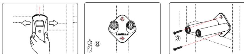
**STAP 1** Gebruik een balkzoeker om de locatie van de bestaande balken in de muur te bepalen en te markeren.
