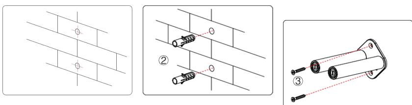
**SCHRITT 1** Positionieren Sie die Träger der WANDHALTERUNG **1** an der gewünschten Stelle und markieren Sie die Mitte der oberen und unteren Löcher.
